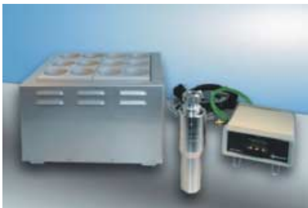
Cuadro 1: Sistema de la digestión a presión del acero inoxidable con un regulador del bloque y de la temperatura de la calefacción de 12 muestras
